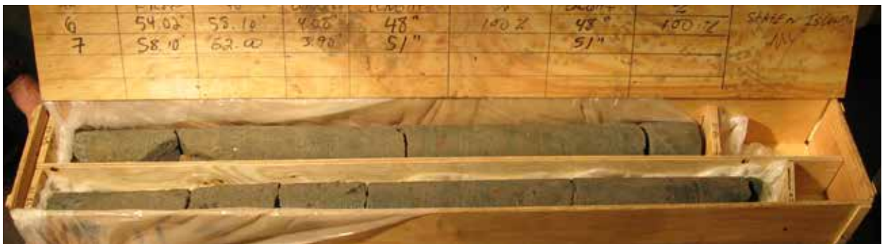
Fig. 11. Carotaggio eseguito nello strato dei depositi alluvionali fini
