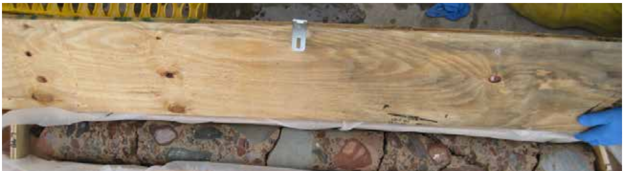
Fig. 12. Carotaggio eseguito nello strato del deposito glaciale con ciotoli e blocchi
