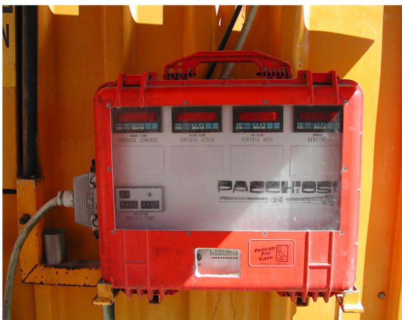
Fig. 2, Sistema di acquisizione e registrazione dati PRS3.
