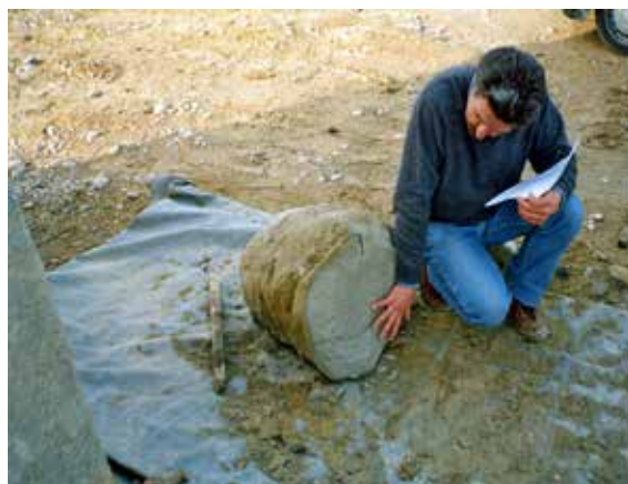
Fig. 3. Immagine dal campo prove di una colonna Jet Grouting.
