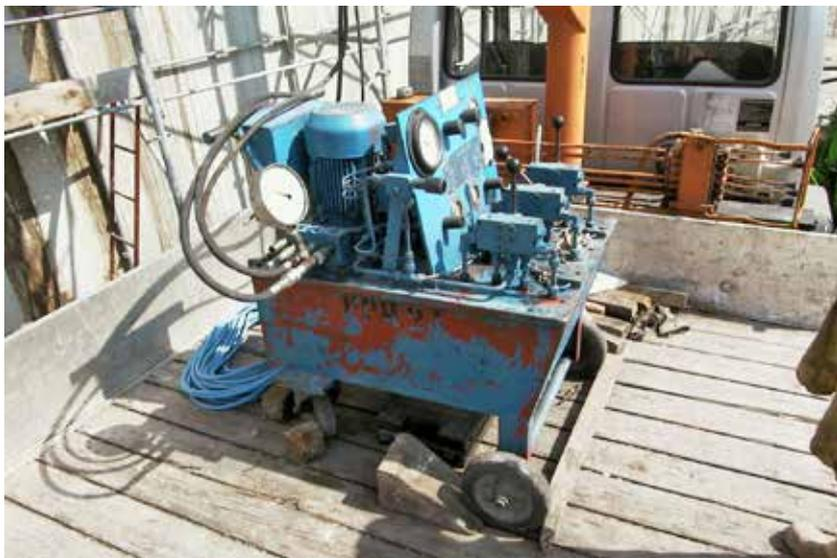
Fig. 12. Centralina di tesatura.
