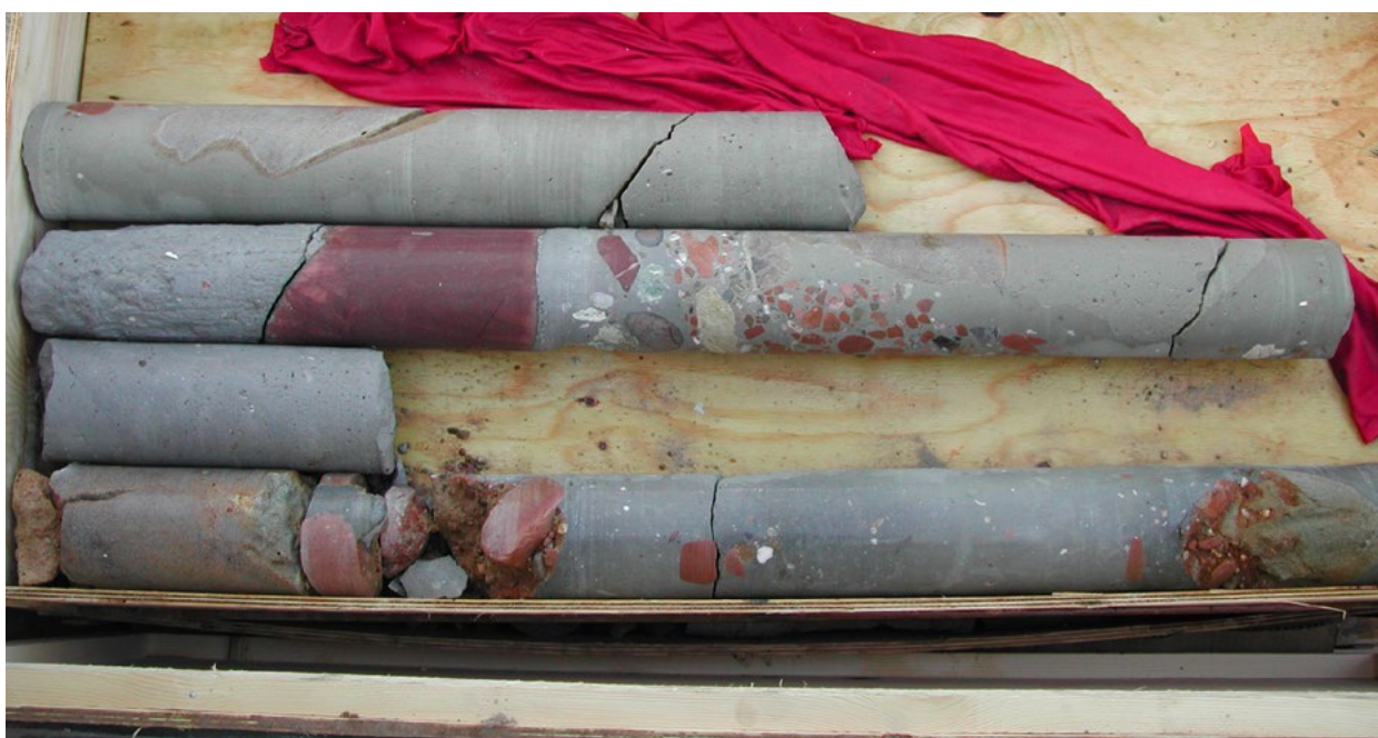
Fig. 22. Esempio di carotaggio; si noti la perfetta cementazione delle inclusioni
