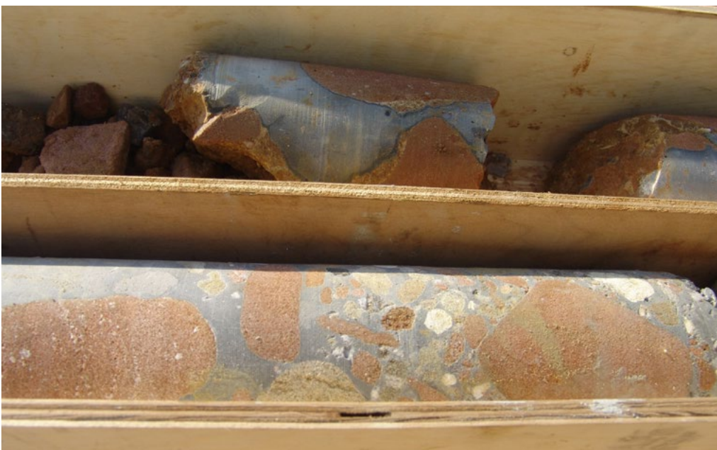
Fig. 20. Esempio di carotaggio; si noti la perfetta cementazione delle inclusioni
