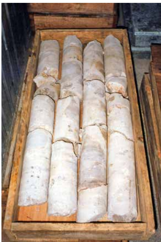
Fig.4.Carote provenienti dal primo campo prove.
