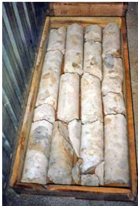
Fig. 6. Carote provenienti dal secondo campo prove.
