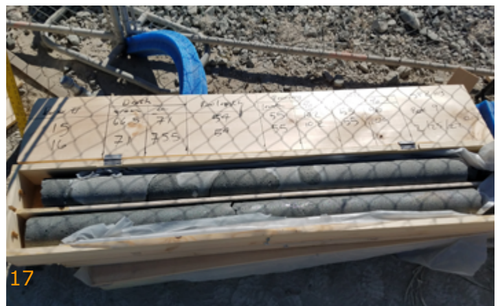
Fig. 15 | 16 | 17 - Controlli eseguiti sulle colonne mediante carotaggi.
