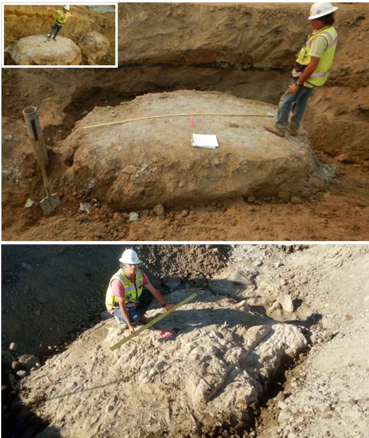
Fig. 11 | 12. Colonne con geometria variabile realizzate nel campo prove.
