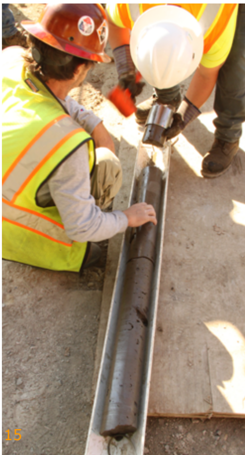
Fig. 15 | 16 | 17 - Controlli eseguiti sulle colonne mediante carotaggi.
