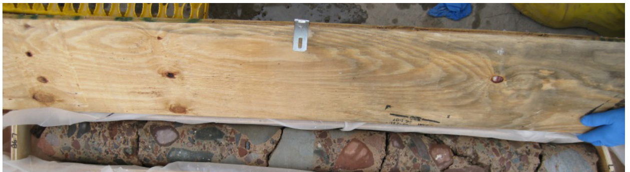
Fig. 12. Carotaggio eseguito nello strato del deposito glaciale con ciottoli e blocchi
